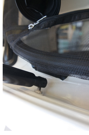
Abb.5 Zur einfachen Montage zunächst beidseitig die oberen Magnete an der Karosserie befestigen
