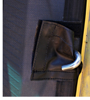
Abb. 3 Die Öffnung ermöglicht die Verwendung einer Feststellvorrichtung zur sicheren Fahrzeugbelüftung.
