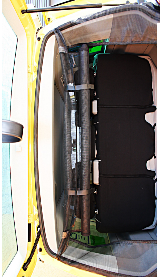
Abb. 2 Das aufgerollte Moskitonetz kann auch bei verschlossener Heckklappe am Fahrzeug verbleiben → Im Fahrbetrieb sollte die obere Einfassung aber heruntergeklappt werden um hundertprozentige Wasserdichtigkeit bei Regen und Fahrtwind zu gewährleisten!
