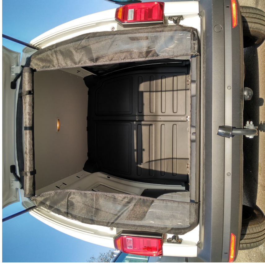
Abb. 1 Der Zugang zum Heck ist durch das Öffnen der beiden Reißverschlüsse ganz einfach möglich. Die Öffnung kann bei Bedarf aufgerollt und mithilfe der oben angebrachten Klettbinden fixiert werden siehe Abb 4.
