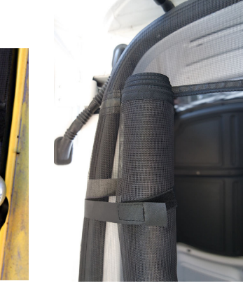
Abb. 4 Fixierung des Zugangs mit Klettbindern
